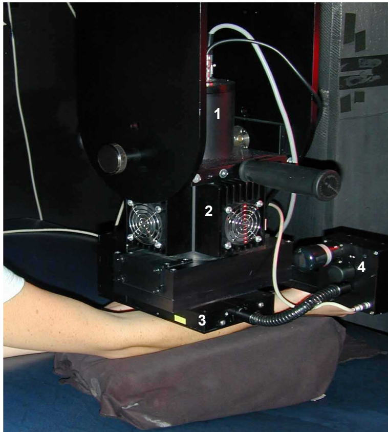
Abb. 4.8: Detektoreinheit des UPE II-Systems im Dunkelraum. (1) HV-Modul und PM. (2) Thermoelektrisches Kühlsystem (Peltier-Kühlelement). (3) Ringlichtshutter. (4) Anregungshutter.
