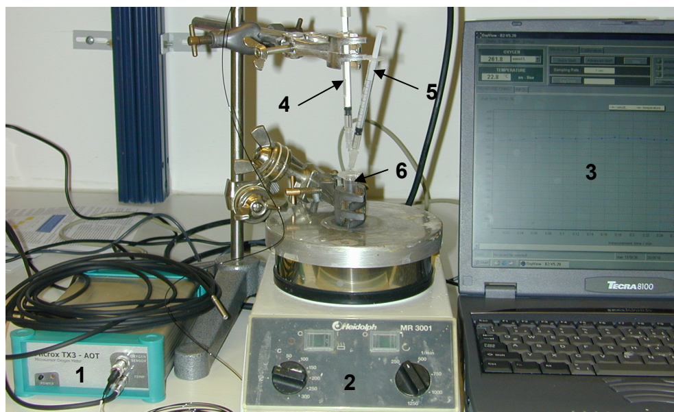
Abb. 4.13: Messaufbau zur oxygraphischen Bestimmung von Wasserstoffperoxid. (1) Messgerät (Microx TX3). (2) Magnetprüher (MR 3001, Heidolph, Kehleim). (3) Notbuck (Tecra 8100, Toshiba). (4) Spritze mit Fasersensor (NTH, PreSens, Regensburg). (5) Insulinspritze mit Katalaselösung. (6) 2 ml Epenndorf-Reaktionsgefäß..
