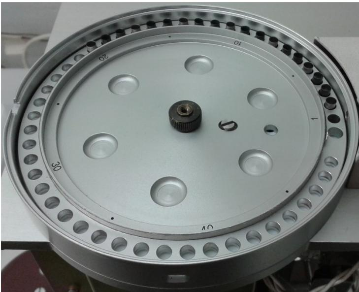
**Abbildung 8:** Teilweise bestückter Probenteller (Pos. 2-20) des automatischen Probengebers mit 48 Positionen (hier ohne Abdeckung).
