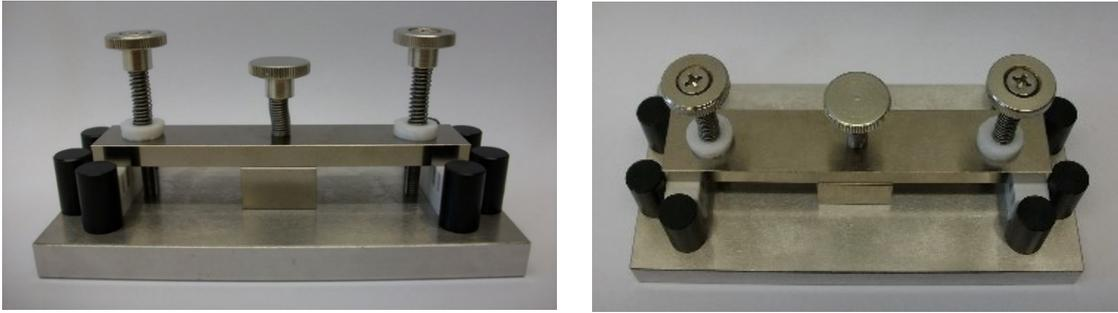
**Abbildung 21: Neue Vorrichtung zum dimensionsstabilen Einbetten in Eis.**
