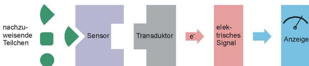
**Abbildung 8 Funktionsprinzip eines chemischen Sensorsystems.**
