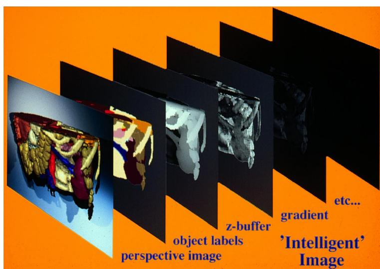
Abbildung 26: „Intelligentes“ Bild: Jeder Bildpunkt enthält neben den Farbwerten auch die Information über das an der Stelle befindliche Objekt, den Tiefenpuffer und den Gradienten.
