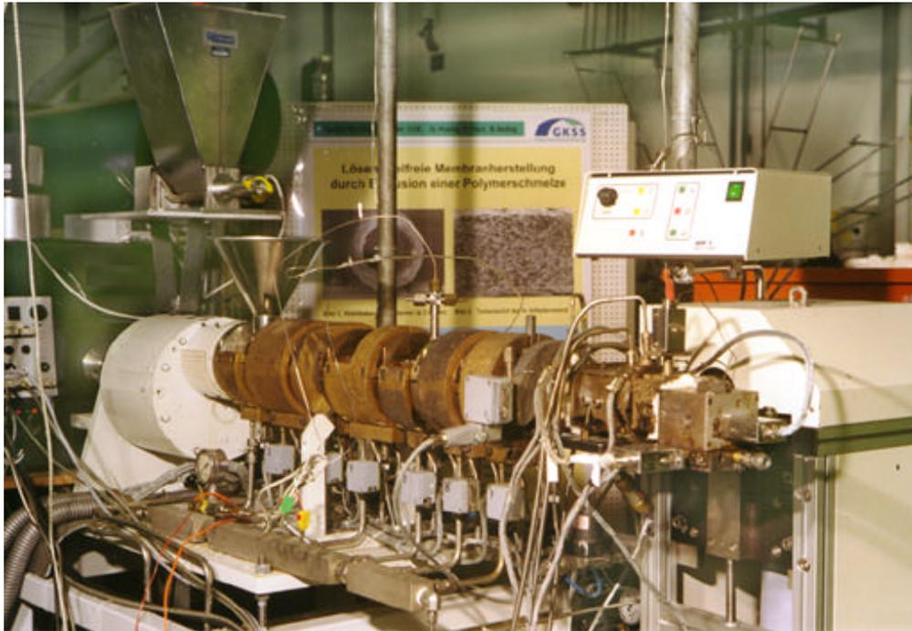
**Abb. 19:** Foto der Extrusionsanlage mit der Zahnradpumpe und dem Extruderkopf.
