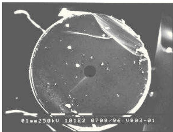
**Abbildung 29:** REM-Aufnahme des Querschnitts einer Glaskapillare (Innendurchmesser: 100 $\mu\text{m}$ )
