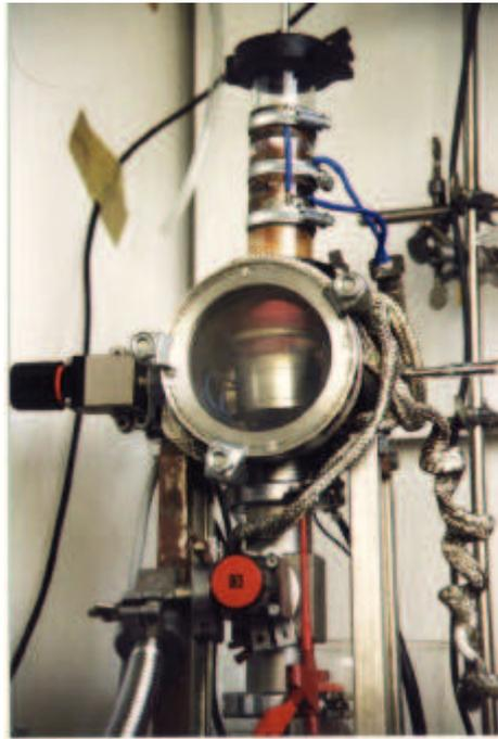
**Abbildung 8:** Remote PECVD-Reaktor
