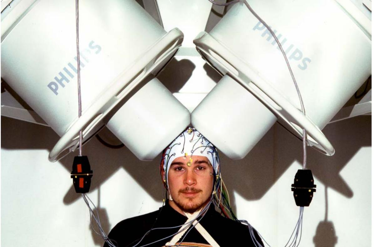
**Abb. 1: Das Philips 31 Kanal Biomagnetometer**
