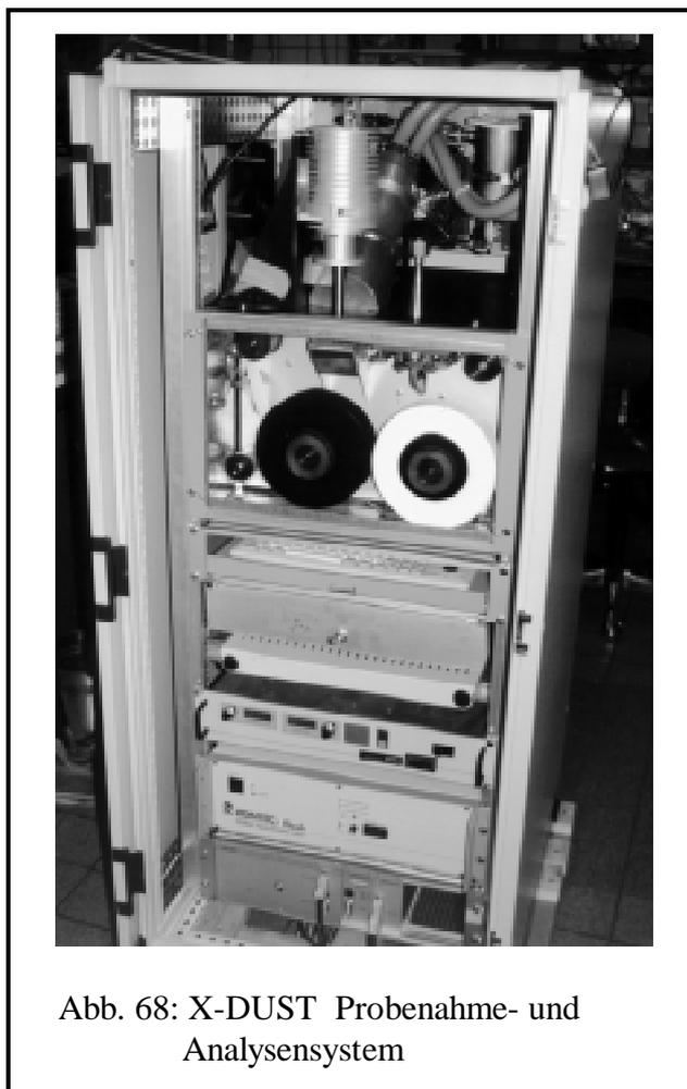
Abb. 68: X-DUST Probenahme- und Analysensystem
