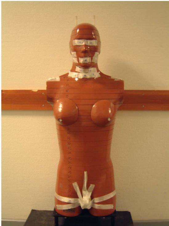
Abb. 3.1: Ein mit TLD 100 H bestücktes Alderson-Phantom
