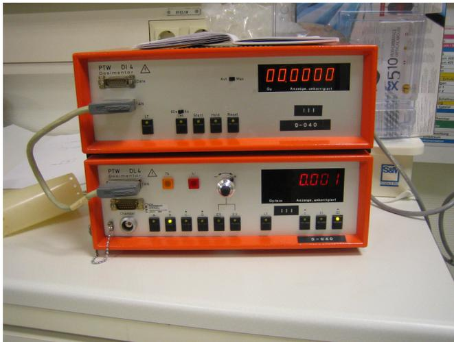
Abb. 4.3: Dosimeter, ein Elektrometer, der die gemessene Ladung erfasst und bei richtiger Kalibrierung die Dosis anzeigt
