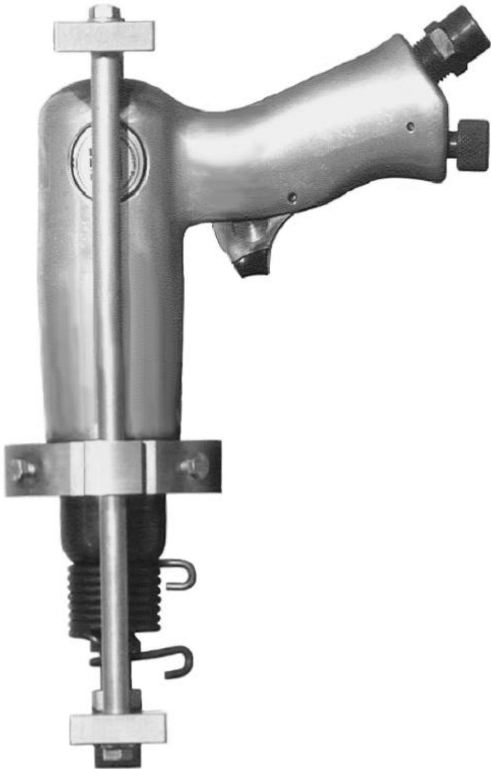
**Abb. 1** Eigener Prothesen-Extraktor Prototyp (TEP-Extraktor)
