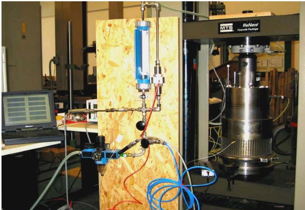
Abbildung 46: Gesamtansicht der Messvorrichtung II zur Messung der Permeabilität
