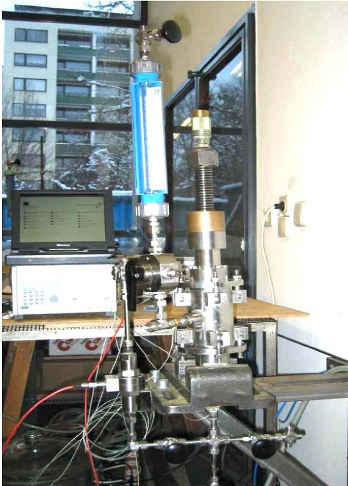
Abbildung 29: Gesamtansicht der Messvorrichtung I zur Messung der horizontalen Permeabilität
