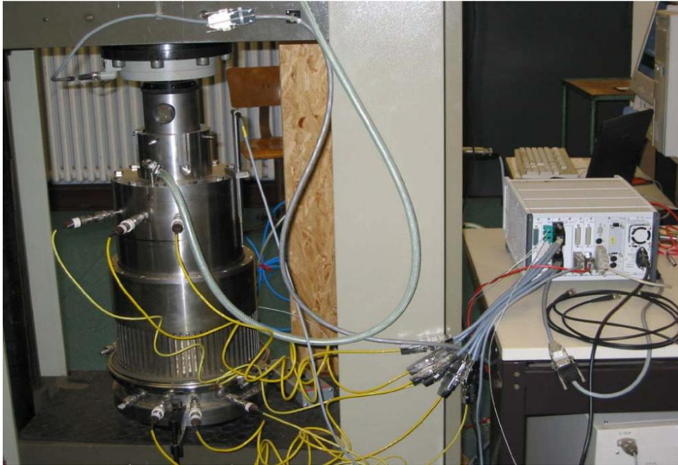
Abbildung 45: Integrierte Messvorrichtung II in einer Prüfmaschine mit an einen Messverstärker angeschlossenen Drucksensoren und Wegaufnehmern
