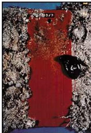
Abbildung 2: Photo einer z. T. mit Antifoulingfarbe behandelten Metallplatte, die längere Zeit Meeresbedingungen ausgesetzt war [35]
