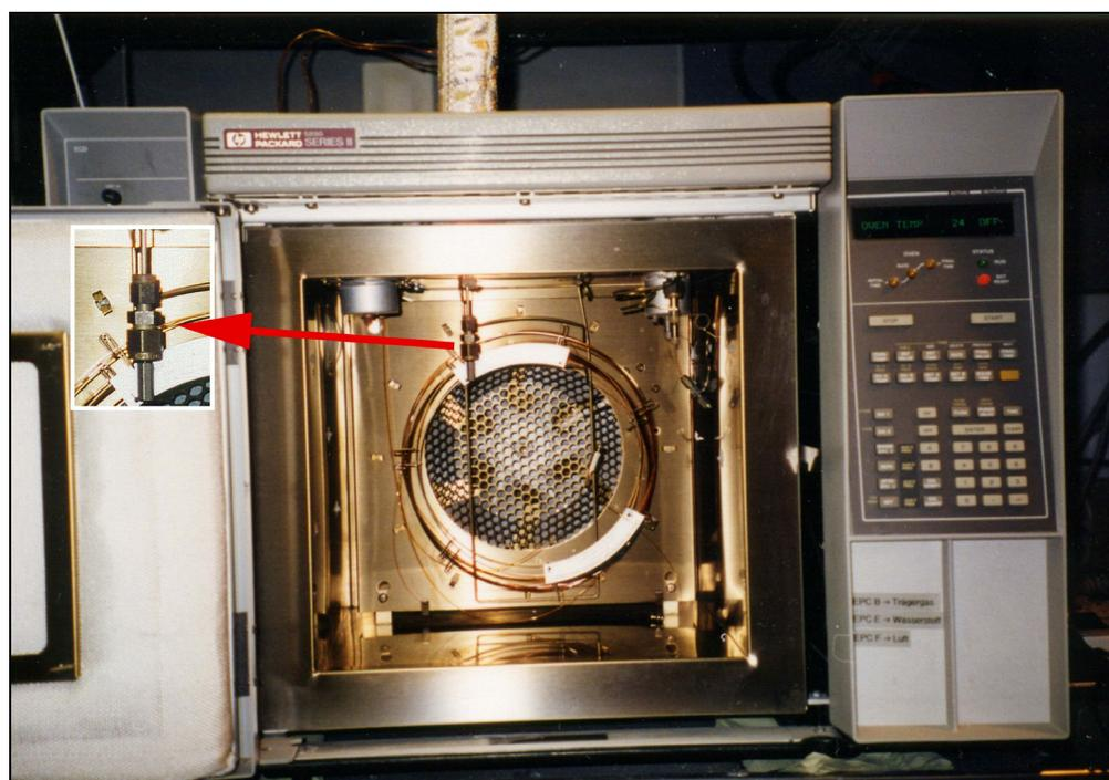
Abbildung 48: Photo der Fixierung der Transferline- Kapillare
