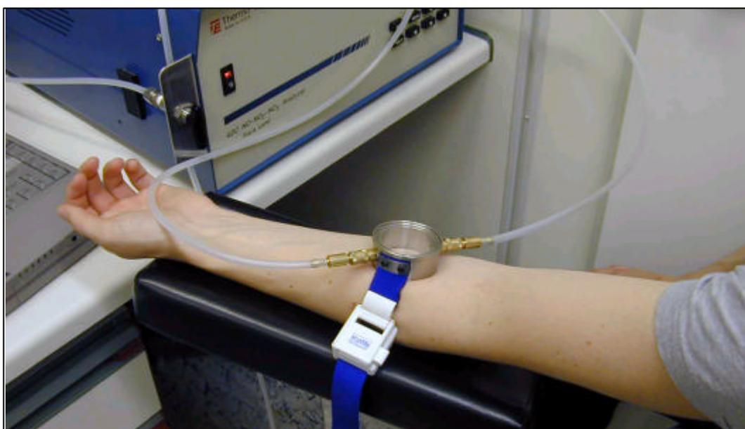
**Abb. 5** Probenahme mittels Trap-Technik
