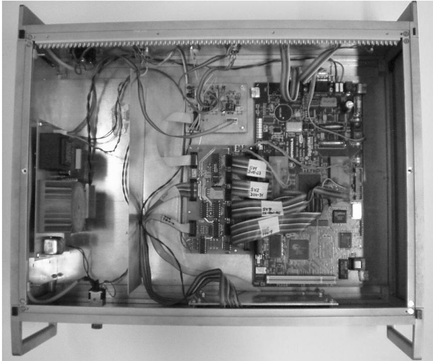
Abb. 32: Foto der Elektronik der Steuereinheit der mobilen Rheoptik (MORO). Links ist die Spannungsversorgung der LCD-Anzeige, des Coldfire-Boards, des A/D-Wandlers, der Verstärker, sowie der Lasersteuerung zu sehen. Die größte Platine rechts ist das Coldfire-Board. In der Mitte befindet sich der A/D-Wandler und oberhalb davon ist die Laseransteuerung mit den Endverstärkern. Unten ist die LCD-Anzeige und oben sind die verschiedenen, in die Rückwand montierten Stecker zu sehen.
