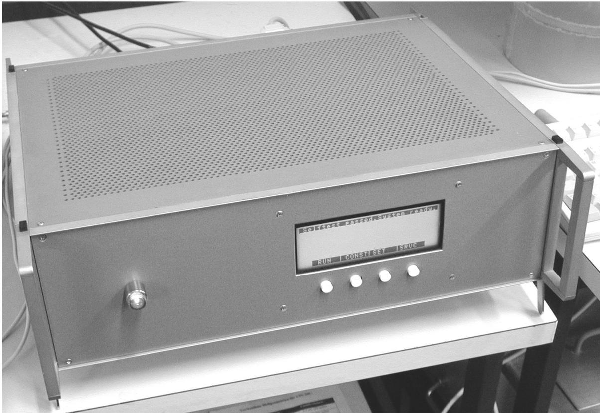
*Abb. 34: Frontansicht der Steuereinheit mit Hauptschalter (links, mit integrierter Kontrolleuchte), LCD-Anzeige und den sich darunter befindlichen 4 Bedientasten.*
