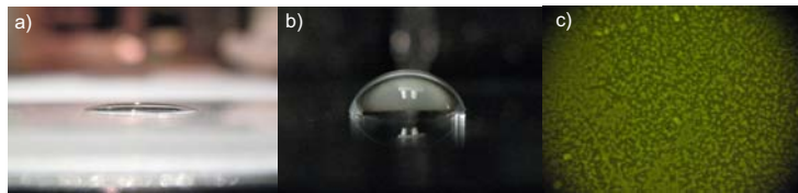
Abbildung 4.29: Bilder aufgenommen mit einem Jenatech inspection von a),b) Kontakwinkel von Wasser auf einem Objektträger a) und b) Objektträger mit MPTMS behandelt. c) zeigt die Fluoreszenz von Nanopartikeln auf der MPTMS behandelten Glasoberfläche.
