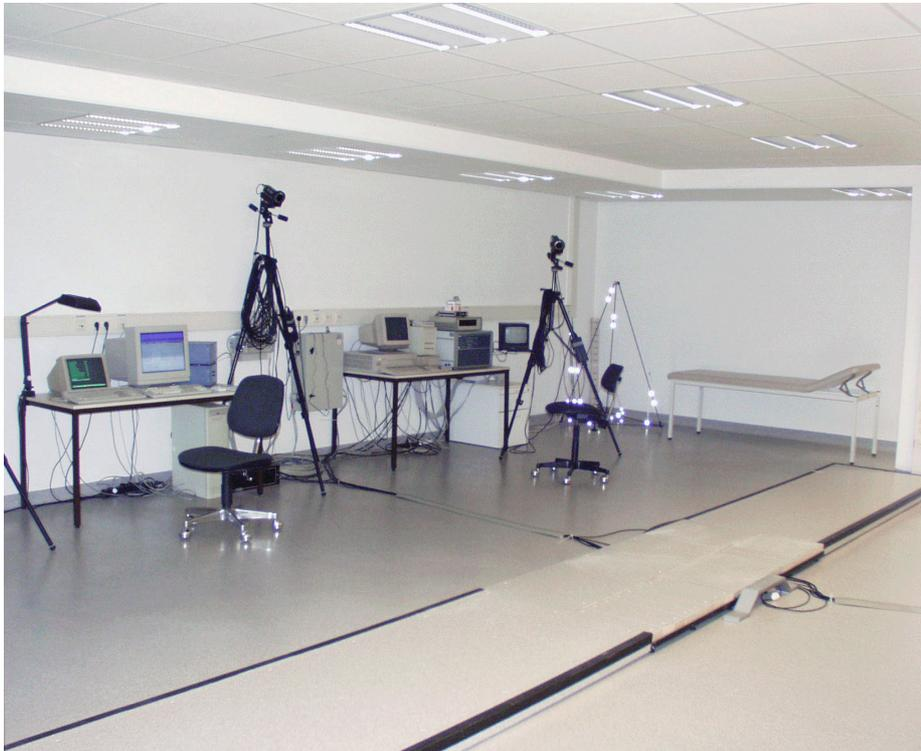
ABBILDUNG 12: VICON-SYSTEM MIT ZWEI DER 6 INFRAROTKAMERAS.
