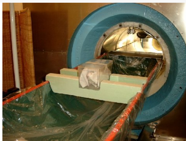
Abb. 2.6: Hamburger Ganzkörper-Radioaktivitätszähler (HAMCO) oben: Schematischer Aufbau des HAMCO. a: 15 cm Stahlplatten (Voratomzeitalterstahl); b: 5 cm Halterahmen (Voratomzeitalterstahl); c: Szintillatorflüssigkeit in Modultanks (je 170 l); d: Vorverstärker auf Photomultiplier-Basis; e: Lichtquellen; A,B,C,D: 50 cm ( 2 \times 2\pi ) Modultanks; 1,2,3,4: Du Mont-K 1328-Photomultiplier; HP-Ge: zwei GP-Ge-Detektoren (aktuell nicht mehr vorhanden) (Abbildung aus Braunsfurth et al. , 1977); unten: Foto des HAMCO mit ausgefahrener Liegefläche und einer darauf aufgebauten Styropor-Brücke mit Mess-Box für Mäuse.
