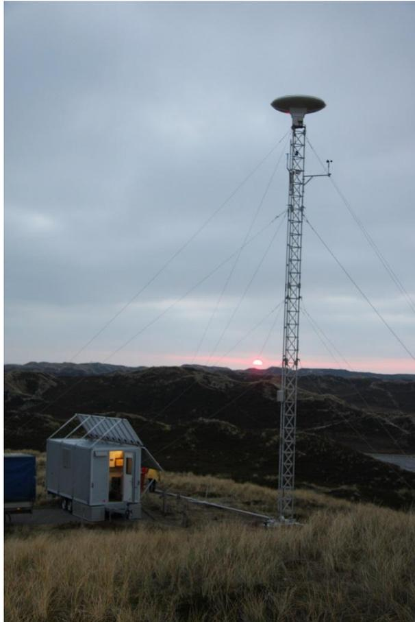
*Abbildung 4.3: X-Band-Radarstation (VV) mit Dom auf dem Ellenbogenberg.*
