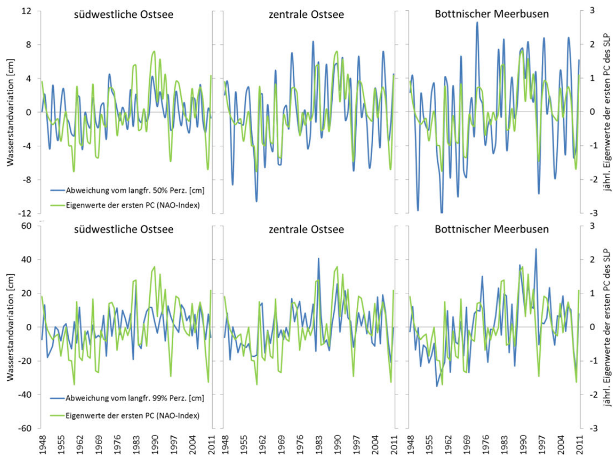
Abbildung 5.14. Zeitreihen der Anomalien der jährlichen mittleren Wasserstände (50% Perzentile oben) und der jährlichen Hochwasserstände (99% Perzentile unten) in cm und jährlicher NAO-Index (Amplitude der ersten EOF des Luftdrucks) (1948-2011).
