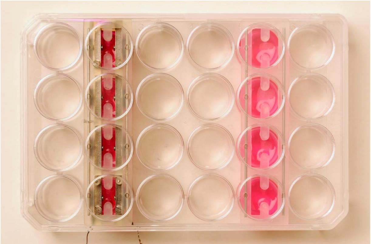
**Abb. 3.1: Fotografische Darstellung einer 24-Well-Platte mit und ohne eingesetzte *Pacing*-Einheit.** Dargestellt ist der Vergleich zwischen dem Einsatz einer *Pacing*-Einheit zur Stimulation von vier EHTs und einer einfachen Silikonhalterung mit vier EHTs zur Kontrolle. Die eingebaute Einheit ist komplett kompatibel mit dem bestehenden 24-Well-Format.
