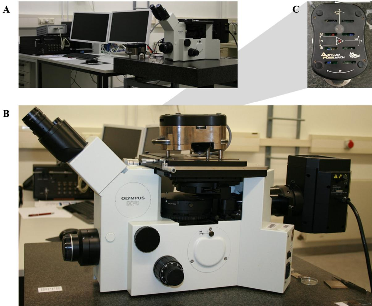
**Abbildung 14: Rasterkraftmikroskop mit (inversem) Mikroskop.** **A.** Alle Elemente des Rasterkraftmikroskops in der Übersicht. **B.** Inverses Mikroskop mit dem Kopfelement, an dem der *Cantilever* befestigt und kalibriert wird. **C.** Kopfelement (Aufsicht).
