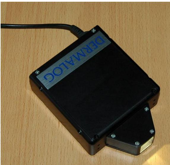
Abbildung 7: Reflexionsspektrometer, Dermalog 17.03.2010
