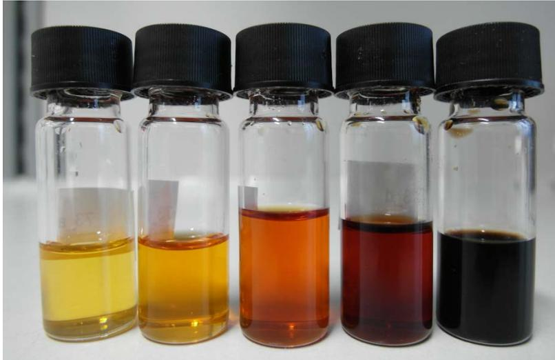
**Abbildung 28: Synthese mit  $\text{PbCl}_2$  als Quelle für PbS-Synthesen aus dem Reaktor**
