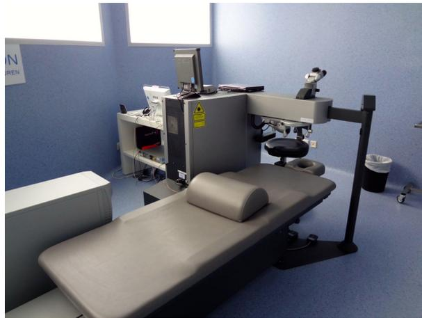
Abbildung 1.3: Wavelight Allegretto Wave Eye Q Laser
