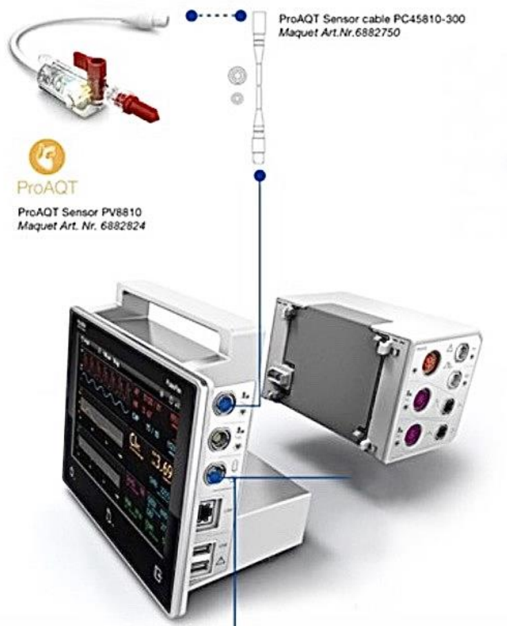
Abbildung 5: PulsioFlex®-Monitor und ProAQT-Sensor (mit freundlicher Genehmigung von PULSION Medical Systems SE).
