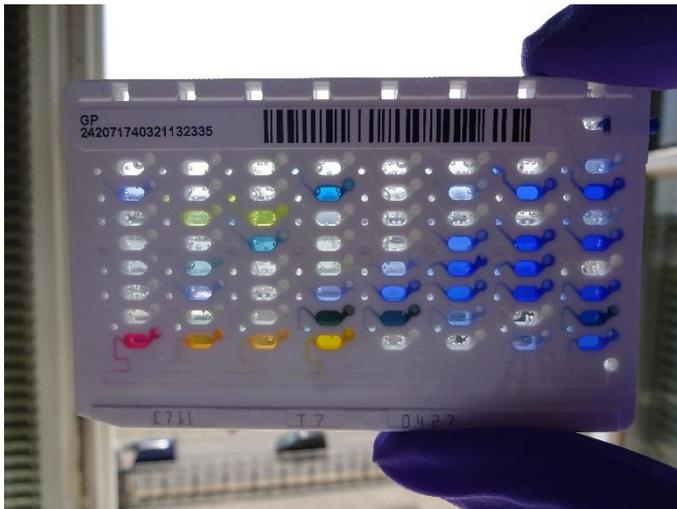
Abbildung 6; VITEK Identifikationskarte nach Inkubation im VITEK-2-compact
