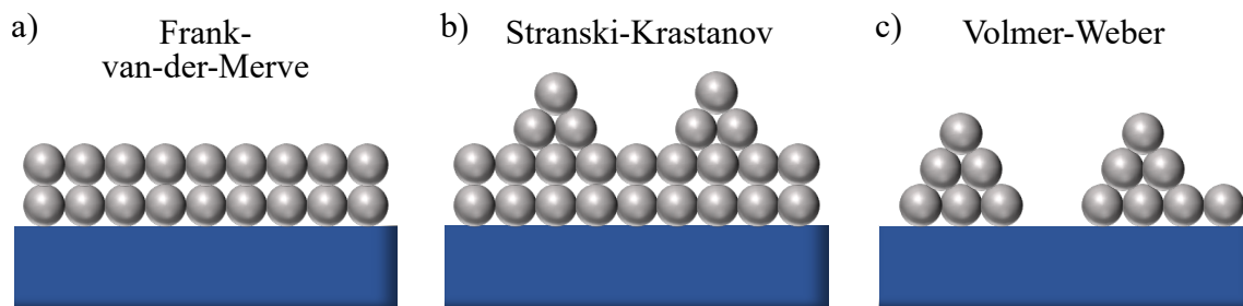
Abbildung 2.9: Schematische Darstellung von unterschiedlichem Schichtwachstum nach a) Frank-van-der-Merve, b) Stranski-Krastanov und c) Volmer-Weber. nach[74]
