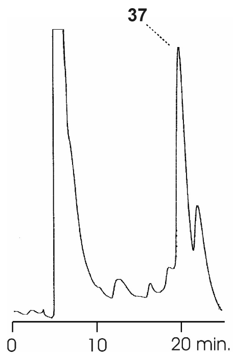
Abbildung 4-51: Präparatives HPLC-Chromatogramm des Gemisches aus 37 und einer weiteren Verbindung (RP-30, MeOH:2-Propanol, 1:1, 0,7 ml/min.)
