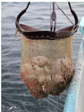
**Abbildung 8:** Dreiecks-Dredsche für die Probenahme im Korsfjord.
