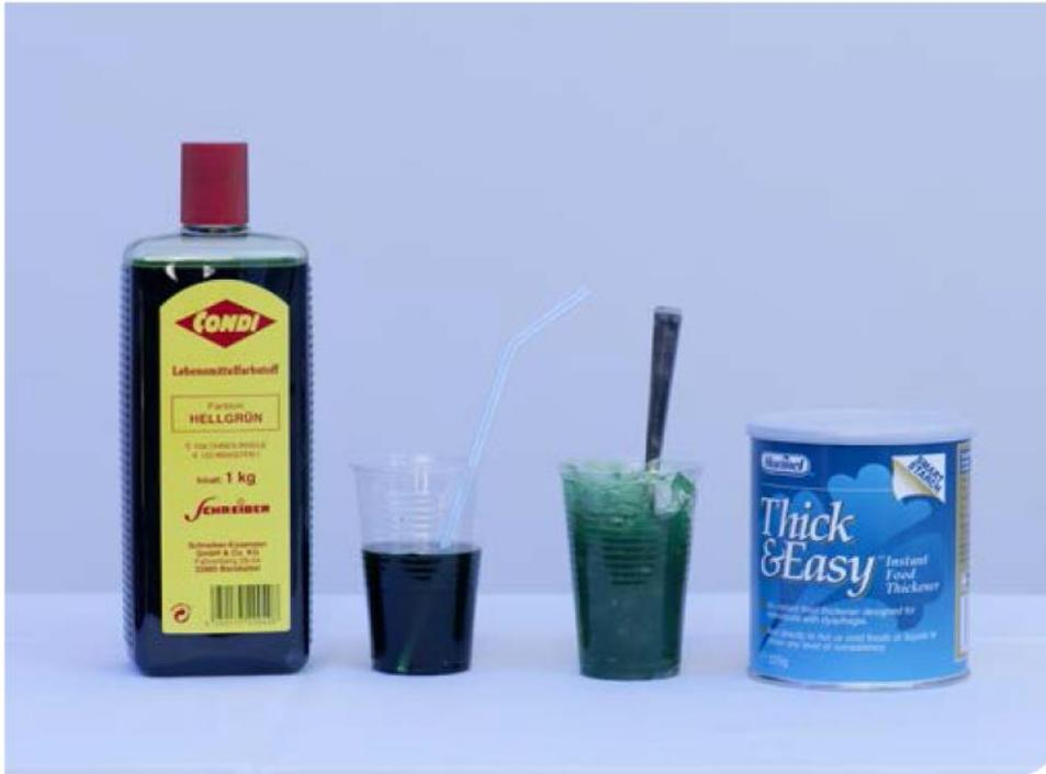
Abbildung 7: Bei den Konsistenzprüfungen eingesetzter Lebensmittelfarbstoff und Andickungsmittel
