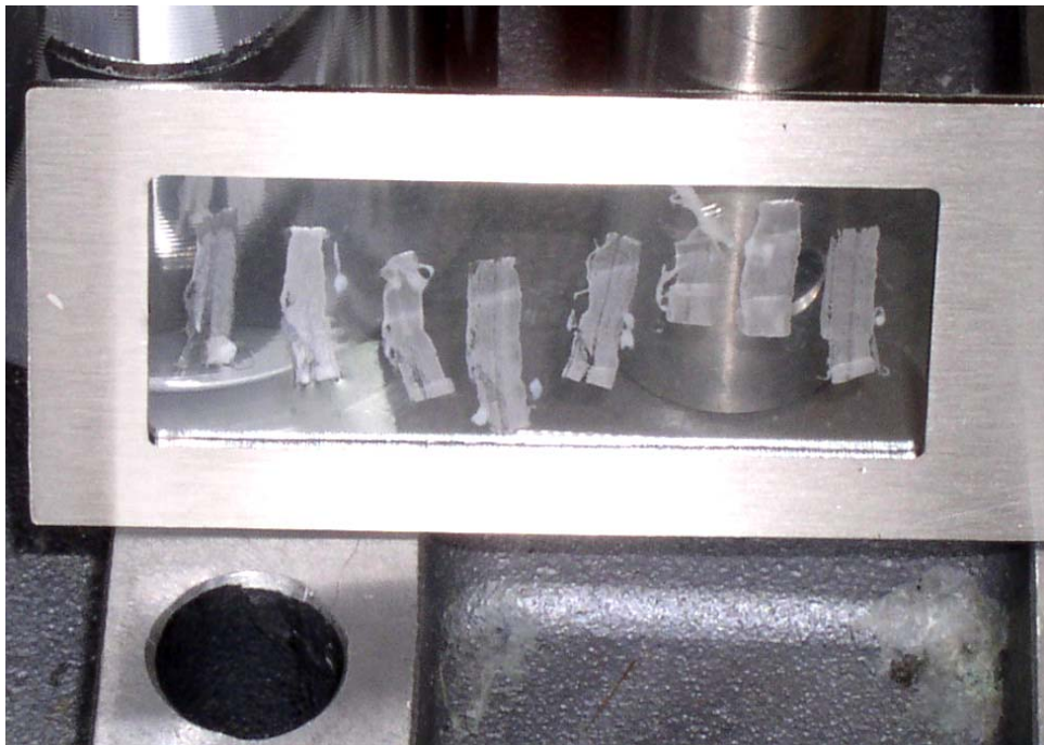
Abbildung 18: Schweinehautdünnschnitte, 20 µm dick, auf Leica-Objektträger mit PET-Folie aufgebracht
