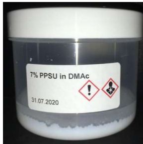
Abb. 63: Fotografien der 7 %ige PPSU-Lösungen in DMAc (a) und DMF (b) nach zweiwöchiger (DMAc), bzw. viertägiger (DMF) Alterung.
