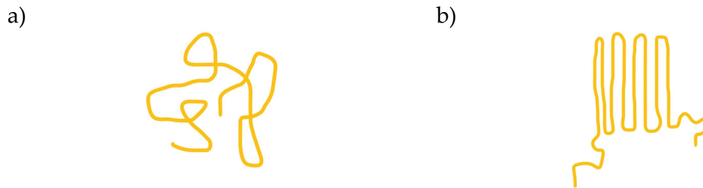
Abb. 60: Anordnung einer Polymerkette in amorphen (a) und kristallinen (b) Bereichen.
