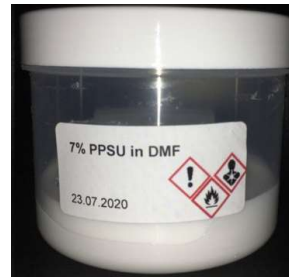
Abb. 63: Fotografien der 7 %ige PPSU-Lösungen in DMAc (a) und DMF (b) nach zweiwöchiger (DMAc), bzw. viertägiger (DMF) Alterung.
