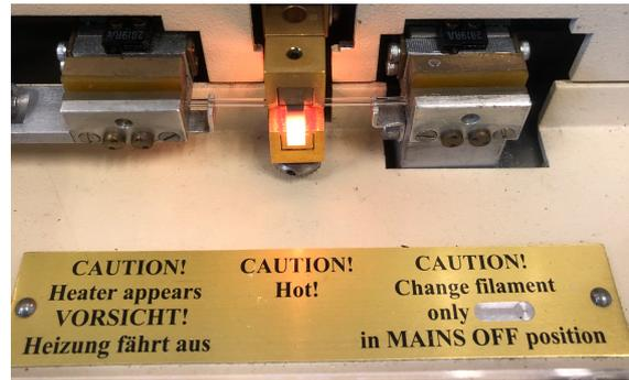
**Abbildung 2.8: Herstellung der scharfen Mikroelektroden.** Die scharfen Mikroelektroden wurden durch einen Elektroden-Puller (A) aus Borosilikat-Glaskapillaren (B) gefertigt.
