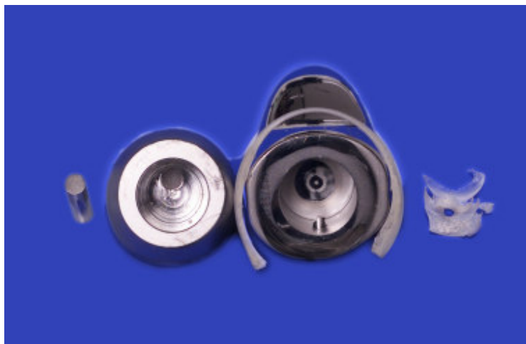
Abb. 11: Das Basisteil mit gebrochenem Sicherungsstift sowie zerriebenem Polyäthyleninlay.
