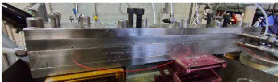
Abbildung 3.5: Ansicht des Reaktoraufbaus mit eingebautem faseroptischem Sensor zur ortsaufgelösten Temperaturmessung längs und quer zum Reaktor.
