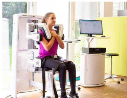
Abb. 1 ▲ Rumpfmuskelkraft-Testgerät Myoline® mit Standardisierungselementen (Oberschenkel-, Becken- und Schulterfixierung) und höhenverstellbarer Schultergürteleinheit (oben) für die Rückenstreckung (Extension), die Rumpfbeugung (Flexion), die Drehung (Rotation) und die Seitneigung (Lateralflexion). (Mit freundl. Genehmigung, © BG Klinikum Hamburg, alle Rechte vorbehalten)
