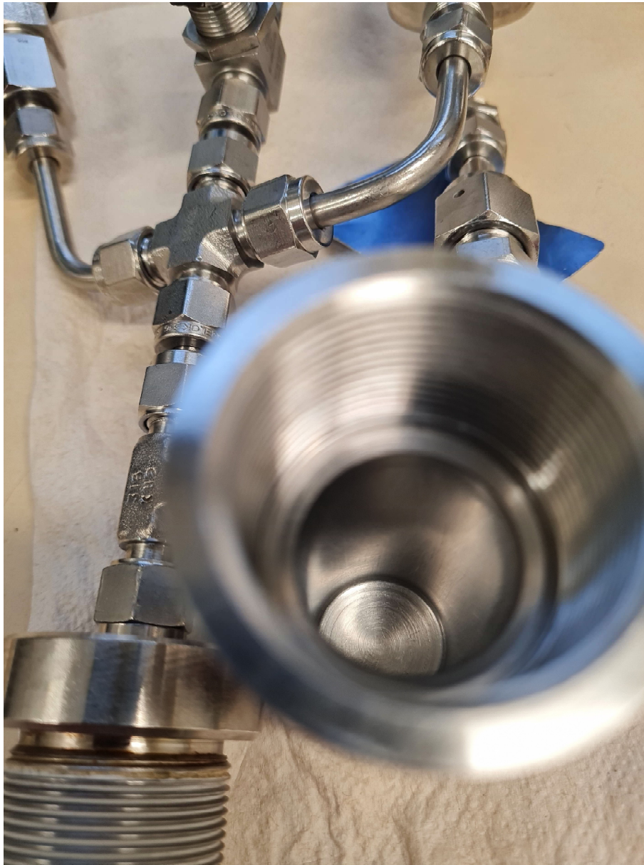
Abb. 43: Zum 10fach Oxidationssystem gehörender Reaktorkörper mit dem zugehörigen Reaktorkopf (Hastelloy (C-276)).
