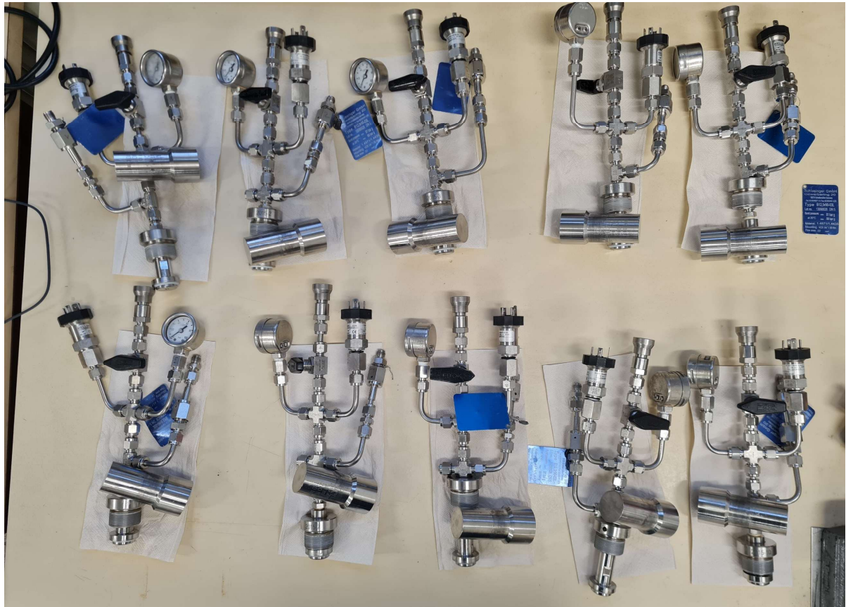
Abb. 44: Zum 10fach Oxidationssystem gehörendes Reaktorset, bestehend aus insgesamt zehn Reaktorkörpern und -köpfen, die wiederum mit einem digitalen und analogen Druckabnehmer ausgestattet sind.
