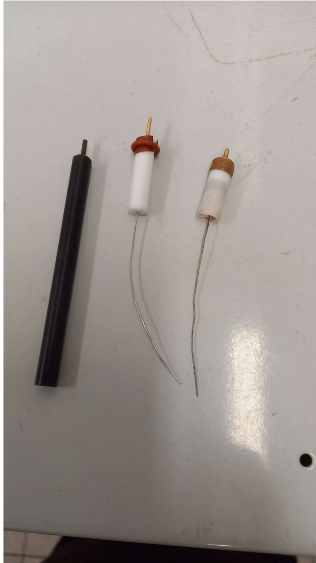
Abb. 41: Elektroden für die CV- und SWV-Messung. Links: Glassy Carbon Elektrode; Mitte: Platinelektrode; Rechts: Ag/Ag + Elektrode.
