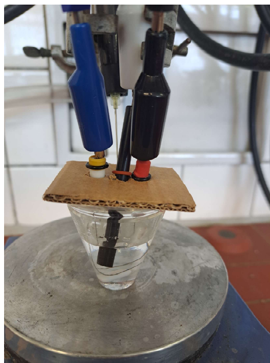
Abb. 39: Messaufbau zur Messung von CV/SWV. Weiße Klemme: Glassy carbon Elektrode; Blaue Klemme: Ag/Ag + Elektrode; Schwarze Klemme: Platinelektrode. Stickstoffspülung erfolgt über die Kanüle.
