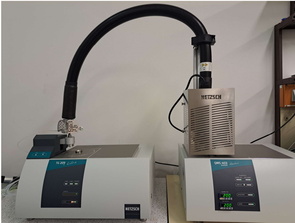
Abb. 36: TG 209 F1 Libra der Firma NETZSCH zur Bestimmung des Hydratwassergehaltes mit gekoppelten Massendetektor (Aelos).
