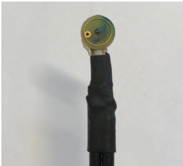
Abbildung 7: Aufsicht auf den Kopf der WASP-Reizelektrode (Speciality Developments, Bextley, UK)
