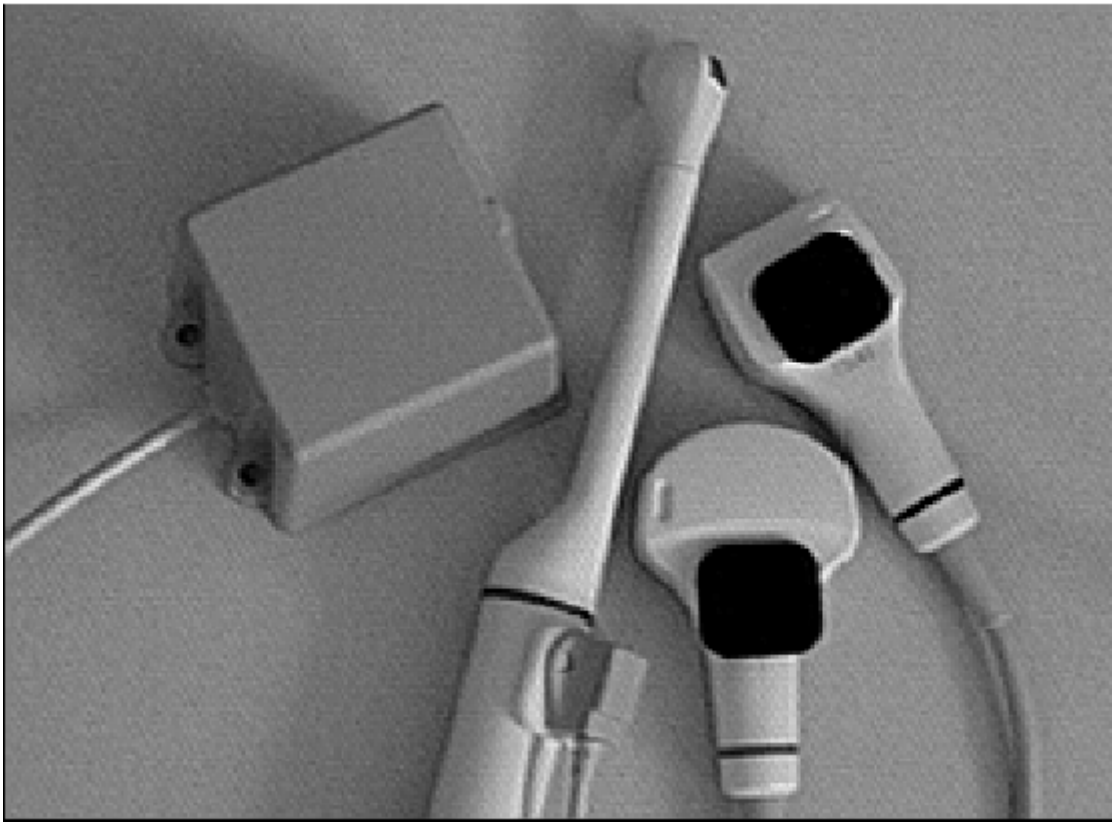
Abbildung 3.2.2: Tracking-System der Firma '3D-Echotec'. Der Quader links im Bild ist der Magnetfelderzeuger. In der Mitte ist ein länglicher Schallkopf dargestellt, der z. B. bei gynäkologischen Untersuchungen angewandt wird. An dessen Stiel aufgesetzt erkennt man einen kleinen Magnetfeld-Sensor. Rechts daneben sind noch zwei weitere, etwas größere Magnetfeld-Sensoren abgebildet.
