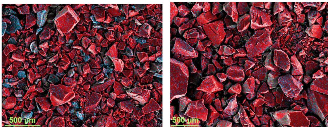
**Abbildung 50:** REM-Aufnahmen mit überlagerter EDX-Kartierung (rot: Mg, blau: Al) zweier GMK-4-HF- $\text{MgH}_2$ -Komposite; links:  $\text{MgBu}_2$ -Imprägnierung erfolgte durch kapillare Imprägnierung, rechts:  $\text{MgBu}_2$ -Imprägnierung erfolgte durch Überschussevaporations-Imprägnierung.
