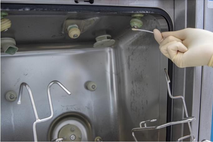
**Abbildung 5** Probennahme der Düsen mit einem angefeuchteten Abstrichtupfer
