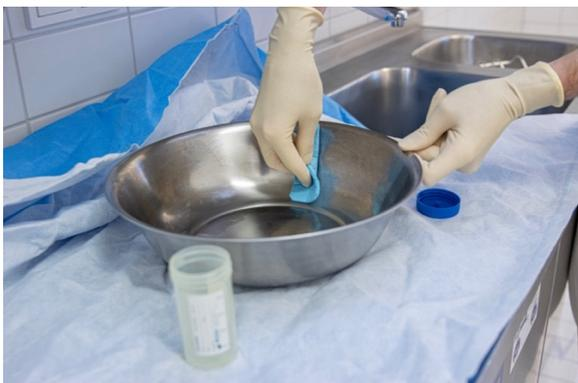
**Abbildung 8** Oberflächenuntersuchung der Innenseite der Waschschüsseln. Die gesamte Innenseite der Waschschüssel wurde mit dem Polywipe-Kratzschwamm ausgewischt.
