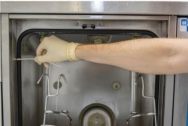
**Abbildung 6** Probennahme Dichtungen. Die Gummidichtung wurde mit einem angefeuchteten Abstrichtupfer umlaufend von jeweils links unten im Uhrzeigersinn bis rechts unten abgestrichen.
