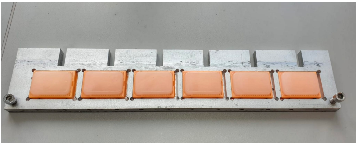
Abbildung 14: TMA-Blockhalter. Das Bild zeigt einen Blockhalter mit sechs leeren Paraffinblöcken (TMA-Empfängerblöcke).
