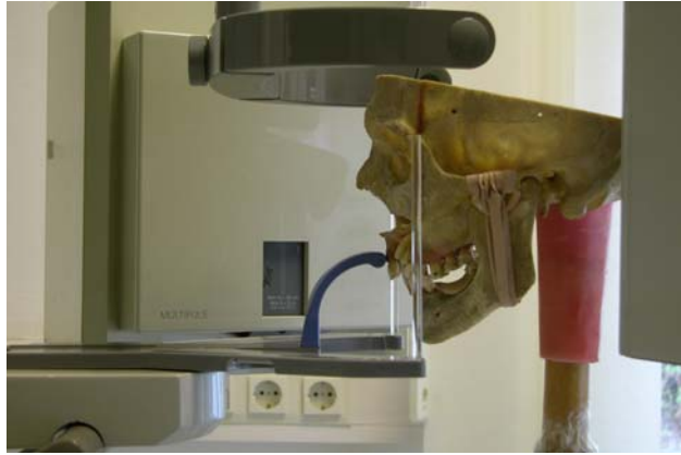
Abb. 3.8: In dem Orthophos Plus ® -Röntgengerät positionierter Phantom-Schädel mit Peilstäben zur Anfertigung einer TSA
