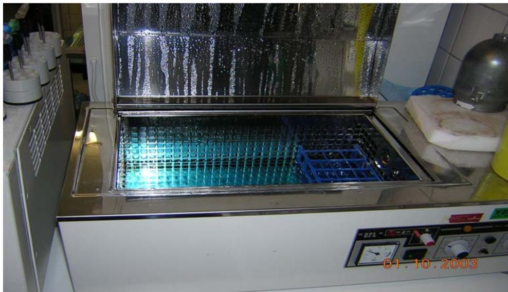
**Abbildung 5 Wasserbad für die Inkubation**
