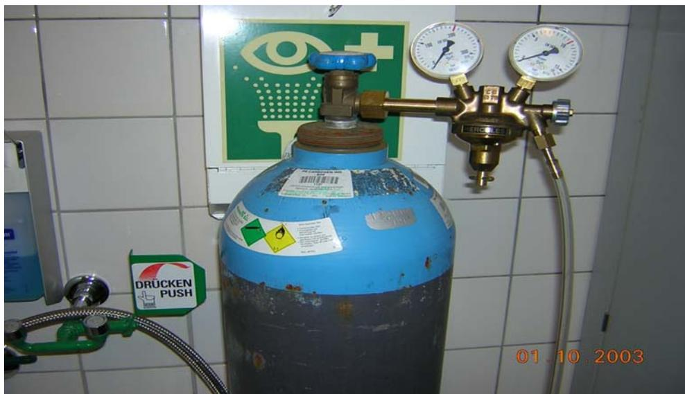
**Abbildung 6 Druckgasflasche mit Carbogen**
