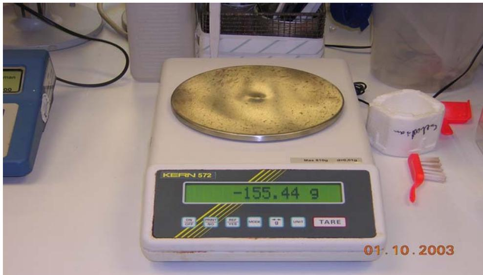
Abbildung 7 Präzisionswaage (Kern 372)
