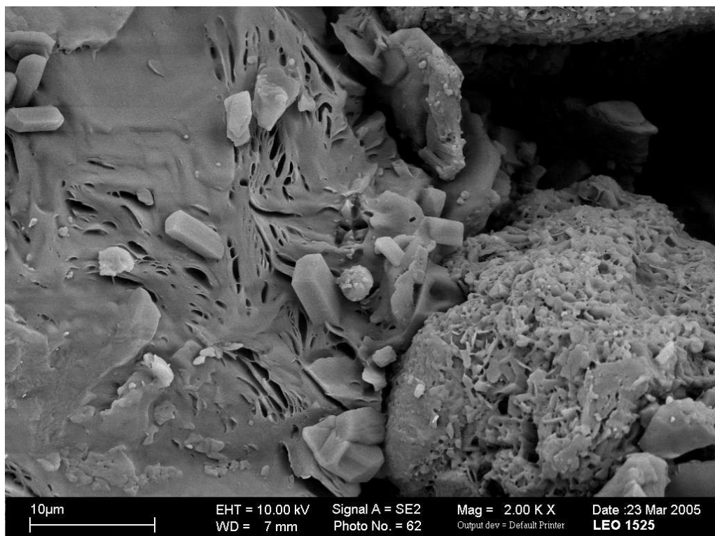
Abbildung 5.80: rasterelektronenmikroskopische Detail-Aufnahme der Bruchfläche einer Tablette mit 70 % (V/V) MC und Fester Dispersion mit 20 % (m/m) Piroxicam bei 2000-facher Vergrößerung.
