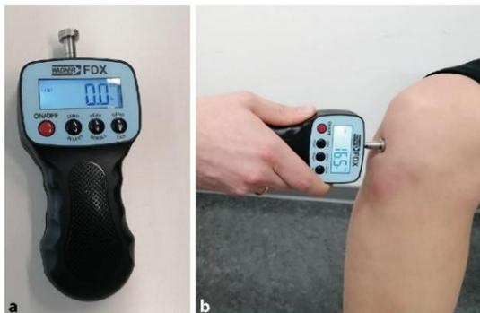
Abb. 2 ◀ Algometer: a Wagner FDX 100 Algometer; b Algometer in Benutzung
