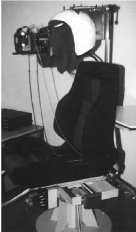
**Abbildung 36:** Seitlich verschiebbarer Drehstuhl (exzentrische Rotation) mit montiertem Helm, Kamera, Blitzgerät (aus Ursula Johst, zur klinischen Bedeutung der exzentrischen vertikalen Rotation zum Nachweis von Otolithenfunktionsstörungen beim Menschen. Freiburg, Diss. 2001, S. 40). Sammlung Werner
