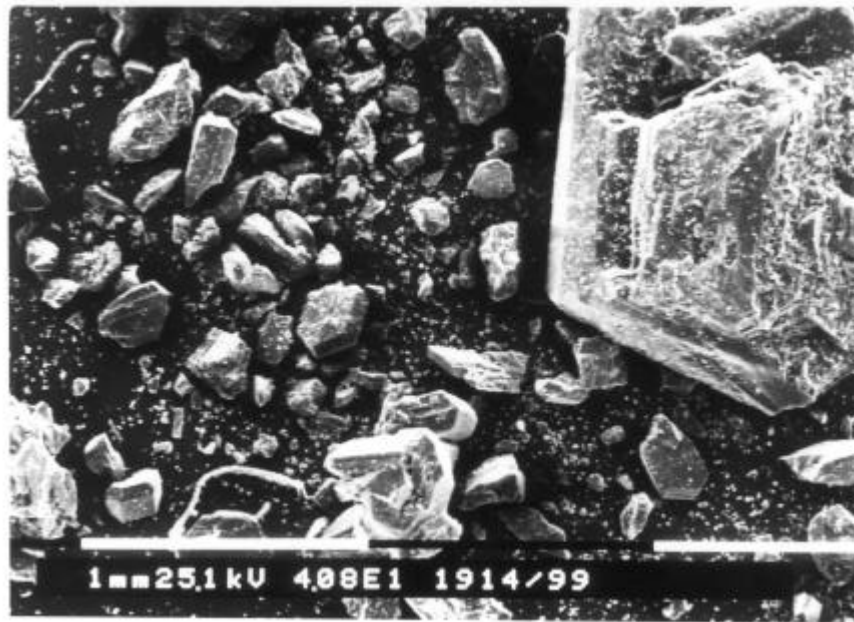
Abb. 6.8: Elektronenmikroskopaufnahme (REM) von sublimiertem Fulleren C_{60} . 40-fache Vergrößerung.
