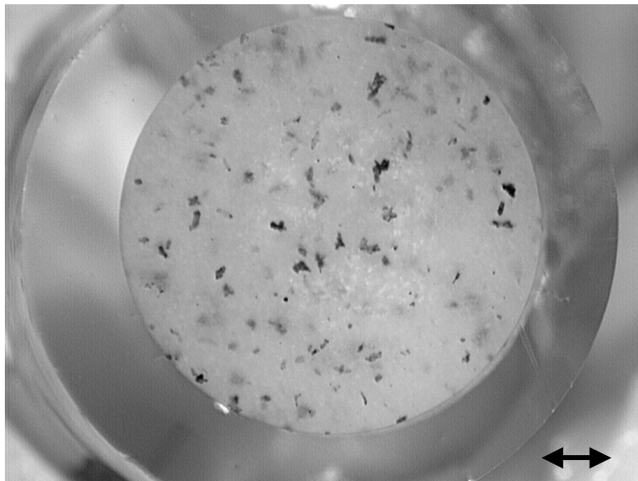
Abbildung 6.35: Bikonvexe Tablette mit 3 mm Durchmesser, radiale Schnittfläche, der eingefügte Balken entspricht 500 \mu\text{m}
