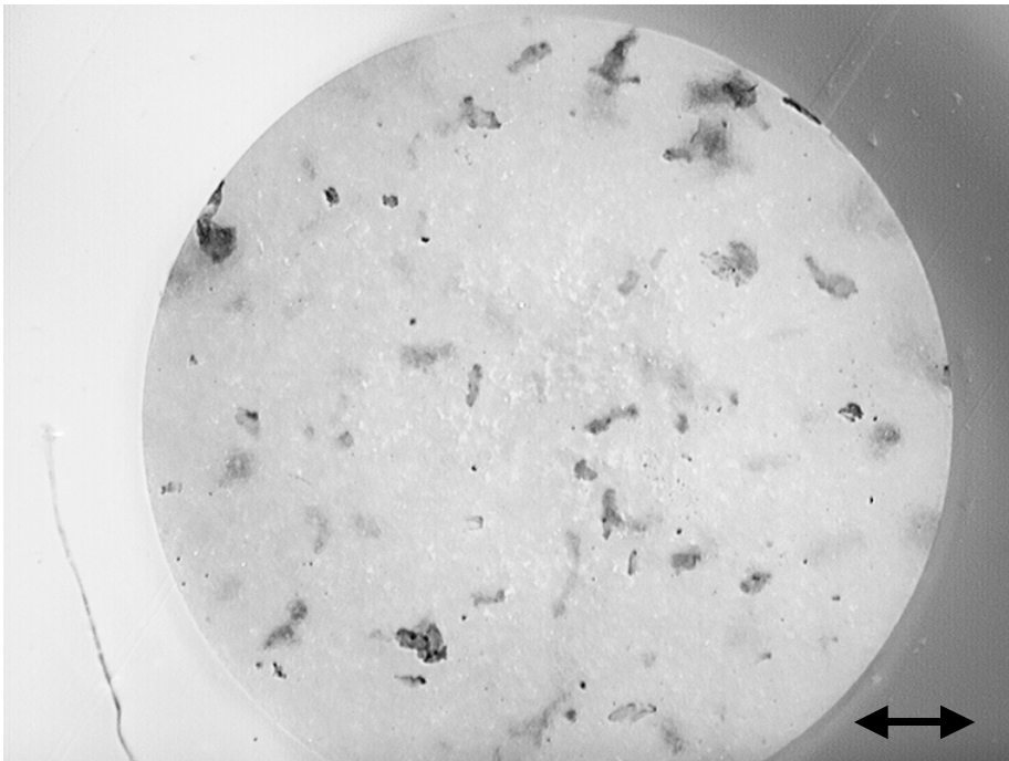
Abbildung 6.29: Biplane Tablette mit 2 mm Durchmesser, radiale Schnittfläche, der eingefügte Balken entspricht 300 \mu\text{m}
