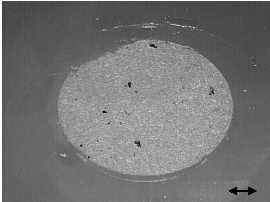
Abbildung 6.55: Biplane Tablette mit 3 mm Durchmesser, Dünnschnitt in radialer Schnittrichtung aus dem direkt an den Oberstempel angrenzenden Bereich, der eingefügte Balken entspricht 500 µm
