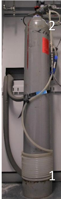
Abb. 15: Wassergeführte Heizung zur Sicherstellung von isothermen Bedingungen in der CO 2 -Flasche während der Extraktion (1 = beheizte Flasche, 2 = beheiztes Ventil) (verändert nach Möck et al. 2023)
