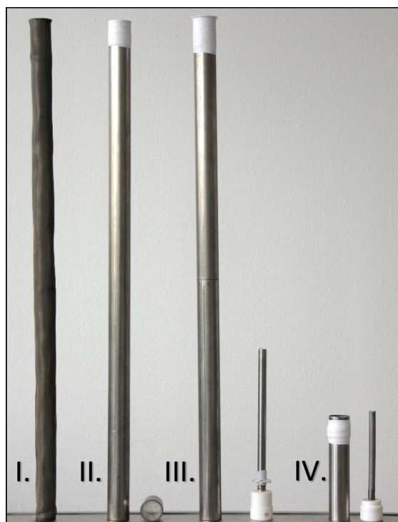
Abb. 21: Extraktionsgefäße für die Extraktion von gebundenem und flüssigem Pyrolyseöl (I. = Siebkorb, II. = Röhre mit Siebkappe, III. = Lange Röhre für Flüssigkeiten, IV. = Kurze Röhre für Flüssigkeiten) (aus Möck et al. 2023)
